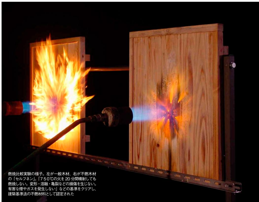
燃焼比較実験の様子。左が一般木材、右が不燃木材の「セルフネン」。「750℃の火を20分間噴射しても燃焼しない。変形・溶融・亀裂などの損傷を生じない。有害な煙やガスを発生しない」などの基準をクリアし、建築基準法の不燃材料として認定された
