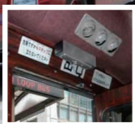
▲路線バスの乗降口に設置された乗降センサー。カウントされた数値は車載CPUとWi-Fiアンテナによって、随時会社に転送される
