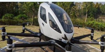
▲空飛ぶクルマは事前にプログラミングすることで無人自動操縦ができる。最高速度は時速130km、1回の充電で約21分間(35km)の飛行が可能。
