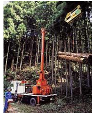
タワーヤード （簡単に架線集材できる移動可能な集材機）
