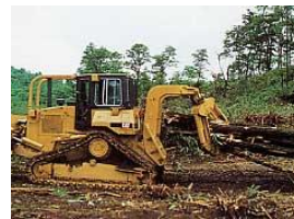
スキッド （丸太の一端を吊り上げて土場まで地引集材する自走式機械）
