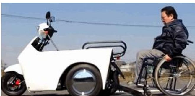
「車椅子専用トライク」の試作車
